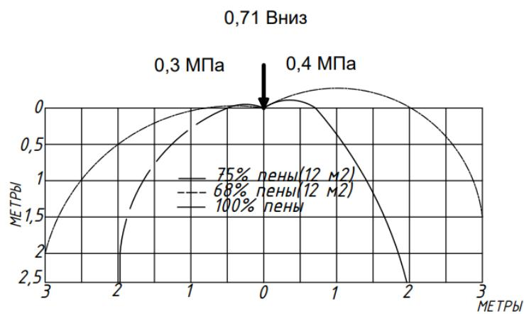
Графики зависимости интенсивности от давления для оросителей водяных и пенных для высоты 2,5 м
